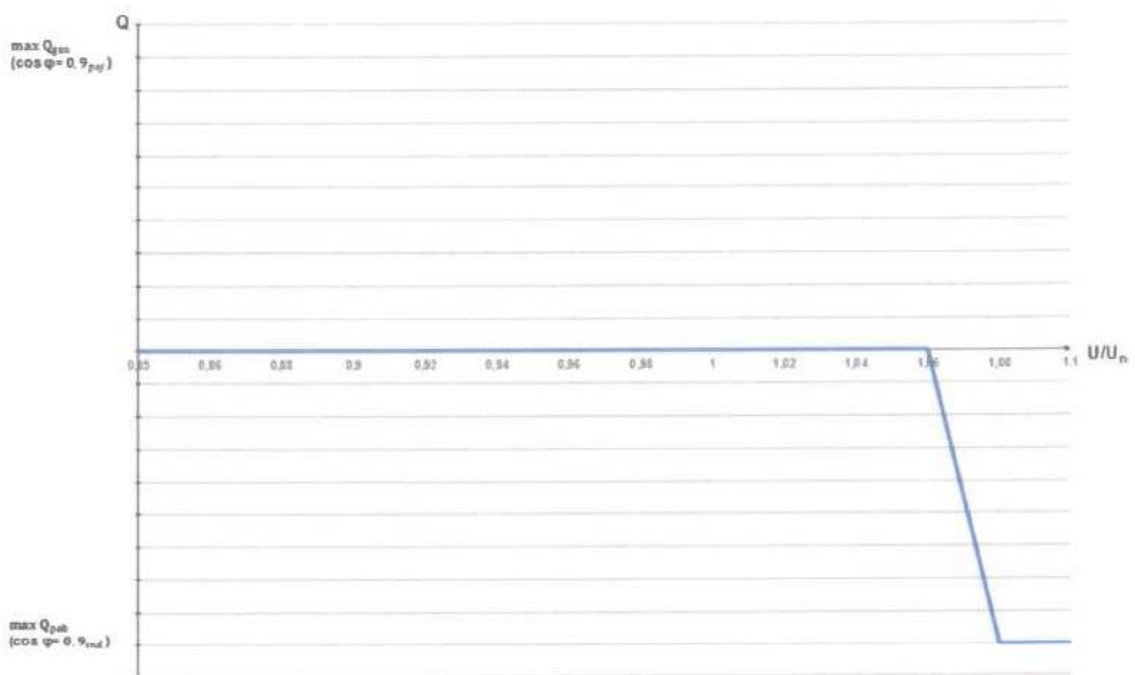
Rys.4. Charakterystyka sterowania mocą bierną w funkcji napięcia dla falowników podłączonych jednofazowo, wymagana przez OSDn.
